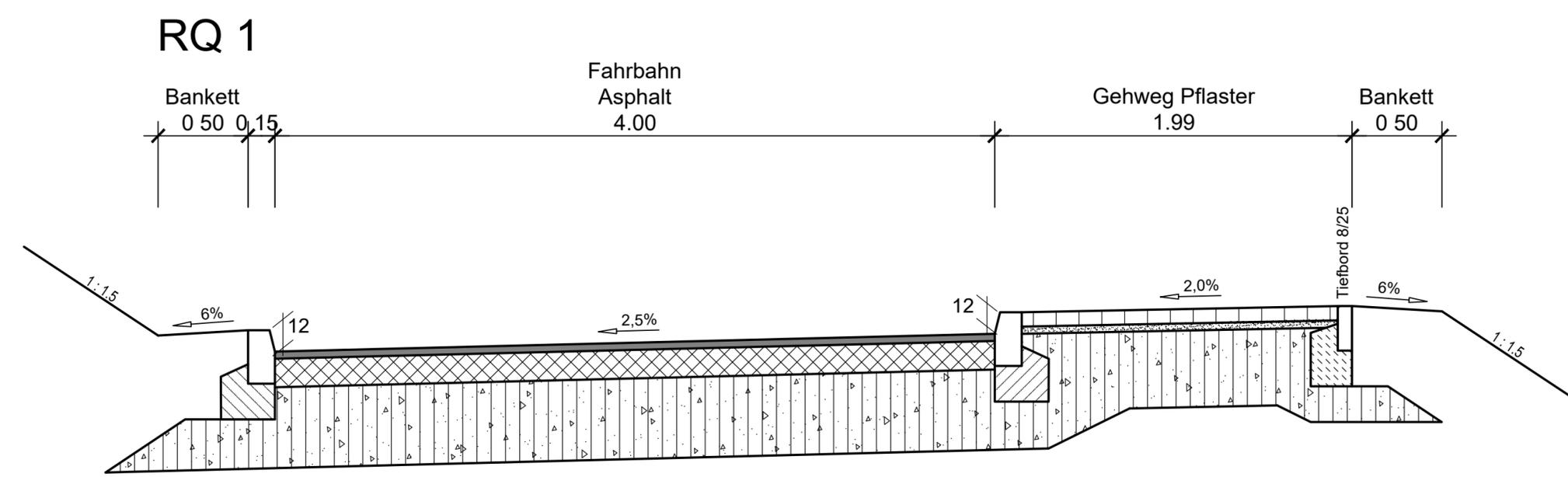
**Oberbau Fahrbahn - Asphalt, Bk 1,8**
